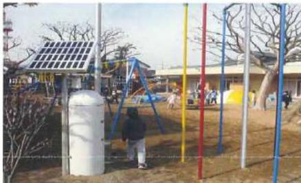
2月4日に保育園の庭に、放射線の空間線量を測る、「放射能モニタリングポスト」が設置されました。太陽光発電によって、常にリアルタイムの線量が表示されています。計測される数値は、今は、0.146μSv/hから0.179μSv/hの間の数字が表示されます。その日の線量数字を見たり、風の強さを見たりしながら、30分以内の園庭遊びをしています。
